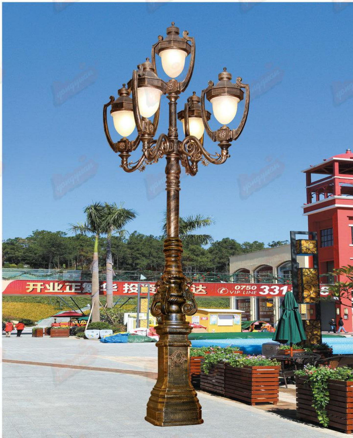
型号：永安名牌2019G379 技术参数：全套铝制品。总高：小号模具有：3米、3.3米、3.5米。中号模具有：3.8米。大号模具有：4.3米、4.8米、5.3米。配PMMA灯罩，配全套喷永安优质户外塑或户外氟碳漆。
