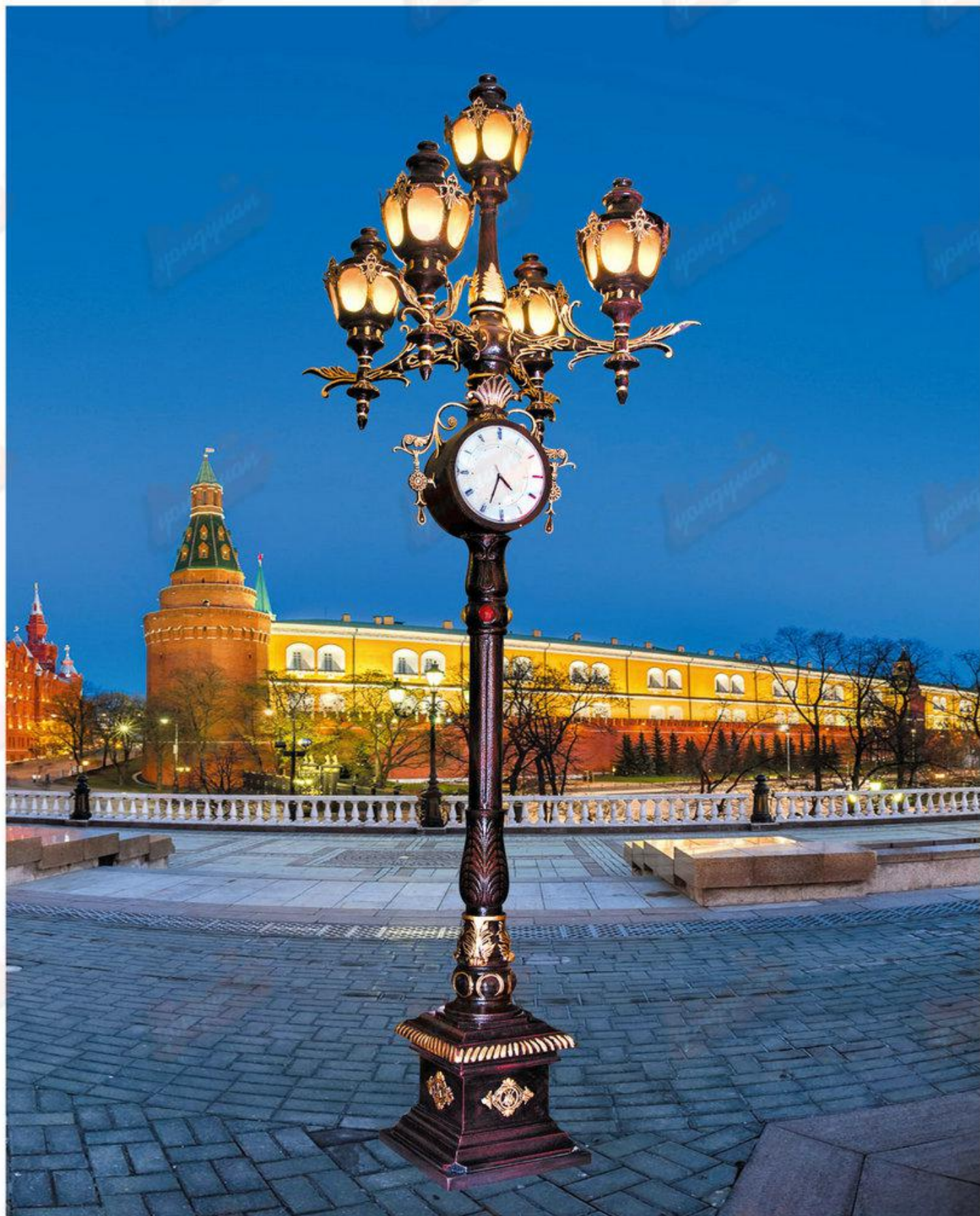
型号：永安名牌2019G213 技术参数：总高5-10m，钢铁、不锈钢制品；配LED光源或节能光源，灯体内外热浸锌防腐处理后喷优质户外氟碳漆或户外塑。
