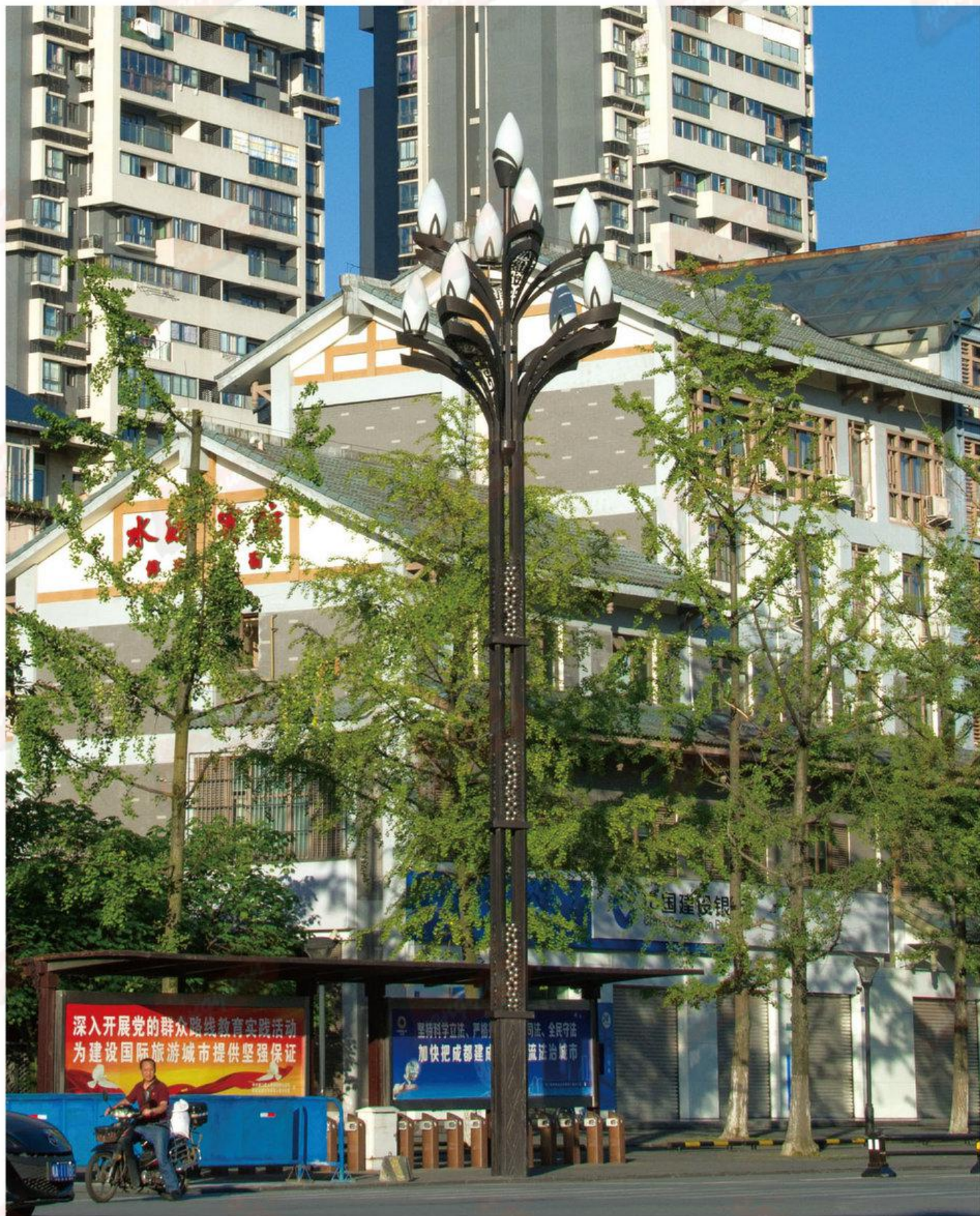
型号：永安名牌2019E25 技术参数：总高6-12m，灯体钢铁制品，装饰花及灯托为沙铸铝制品，配进口PMMA灯罩，光源适配节能灯、LED光源、高压钠灯或金卤灯，钢铁制品内外热浸锌防腐处理后喷优质户外氟碳漆。
