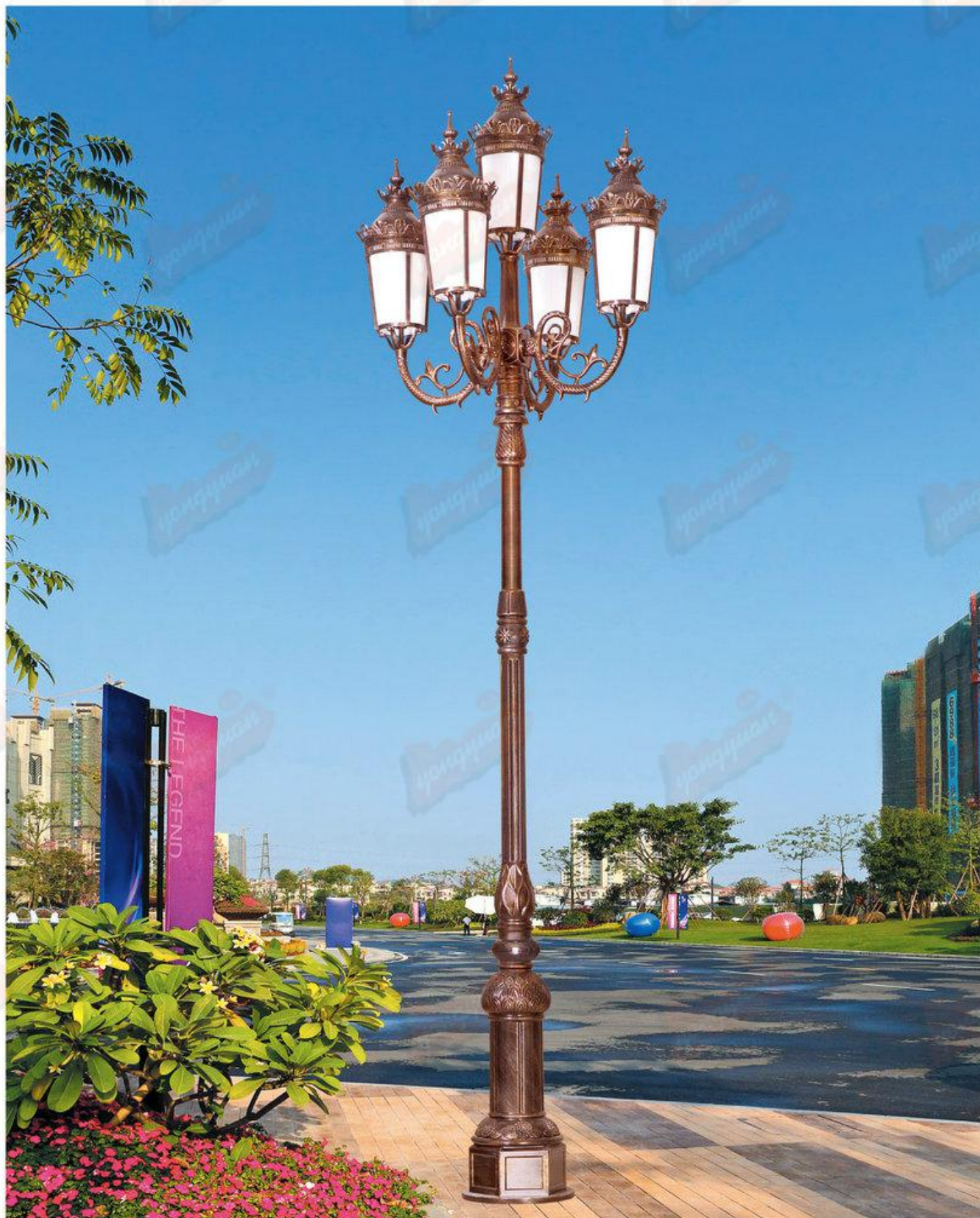
型号：永安名牌2019G109 技术参数：全套铝制品。总高：小号模具有：3米、3.3米、3.5米。中号模具有：3.8米。大号模具有：4.3米、4.8米、5.3米。配PMMA灯罩，配全套喷永安优质户外塑或户外氟碳漆。
