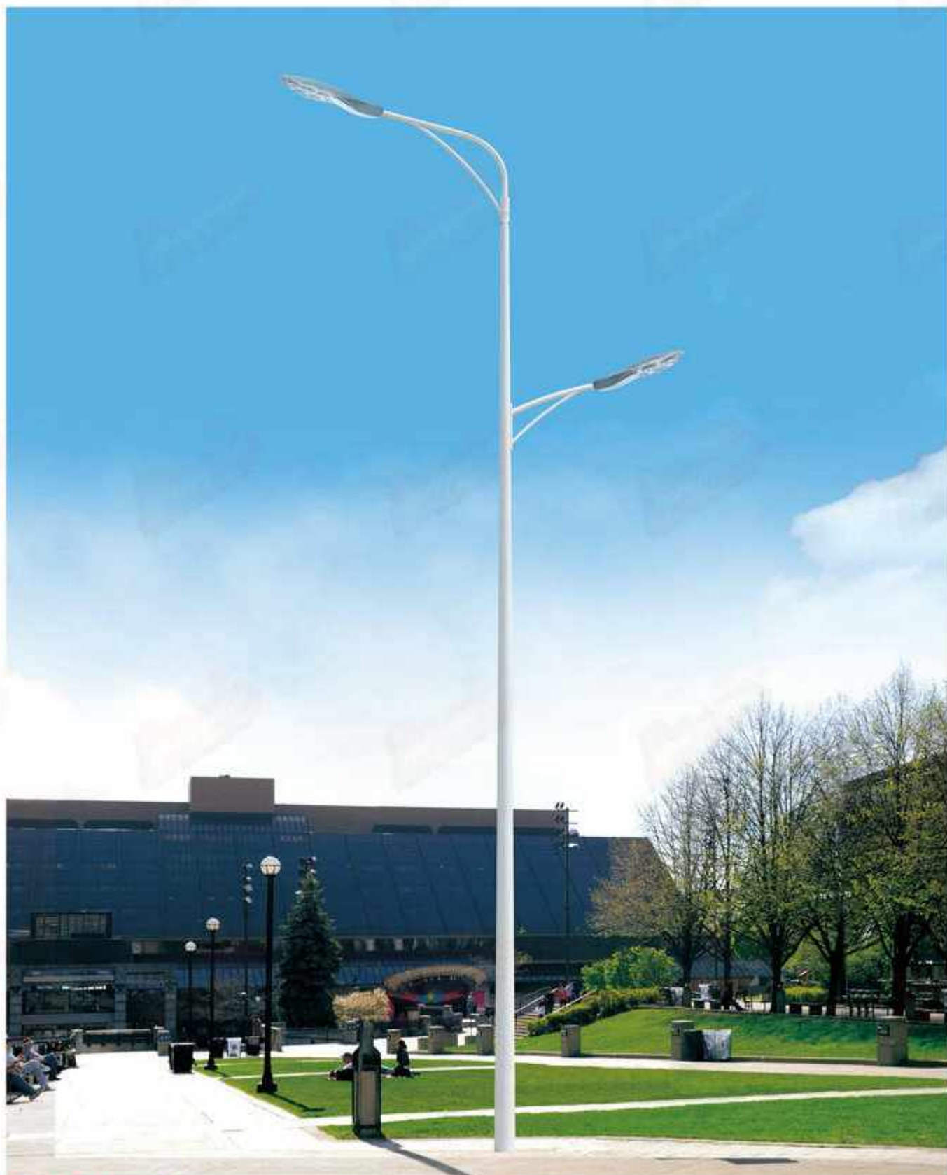
型号：永安名牌2019P65 技术参数：总高8-12m，钢铁制品；灯具铝制品，配LED光源，灯体内外热浸锌防腐处理后喷优质户外氟碳漆，灯体材料为Q235、SS400可供选择。
