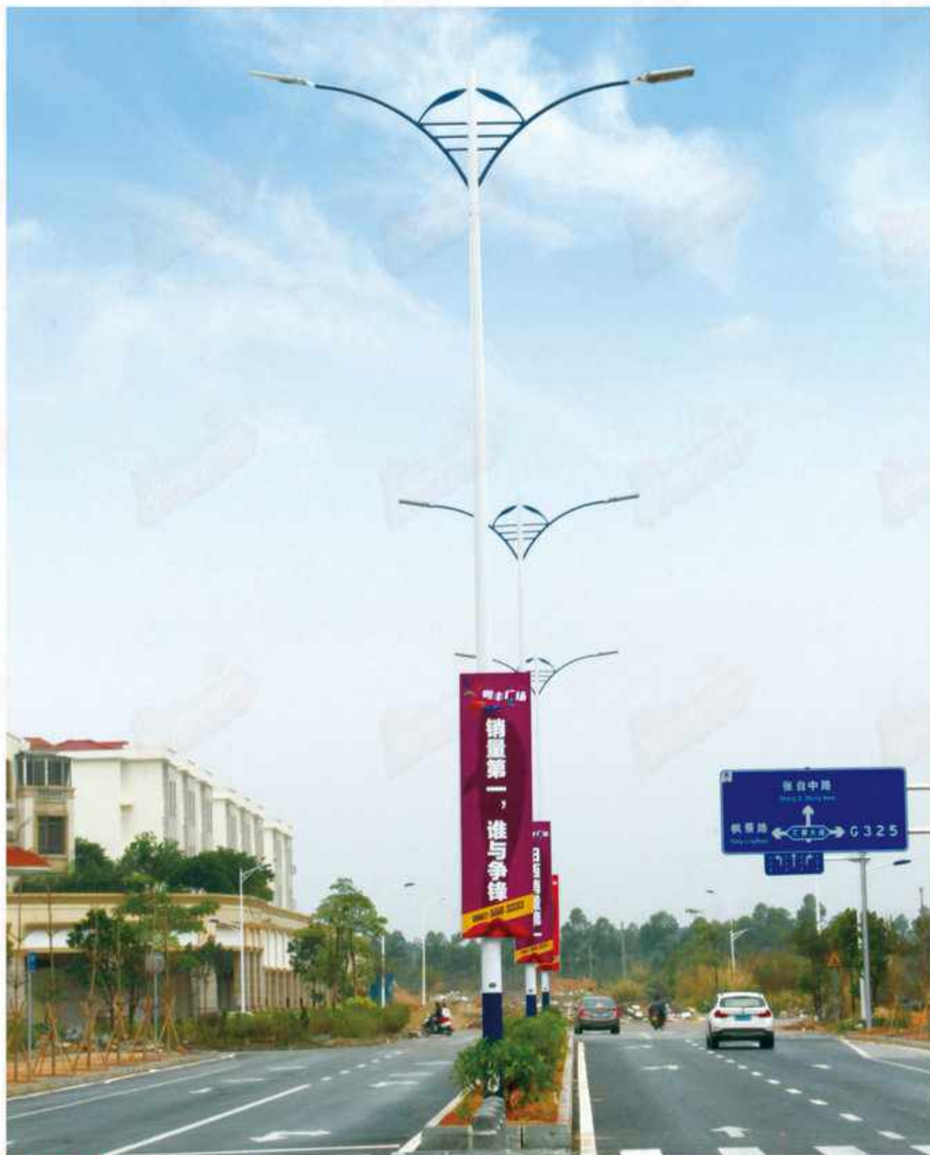
型号：永安名牌2019P3 技术参数：总高8-12m，钢铁制品；灯具铝制品，配LED光源，灯体内外热浸锌防腐处理后喷优质户外氟碳漆，灯体材料为Q235、SS400可供选择。
