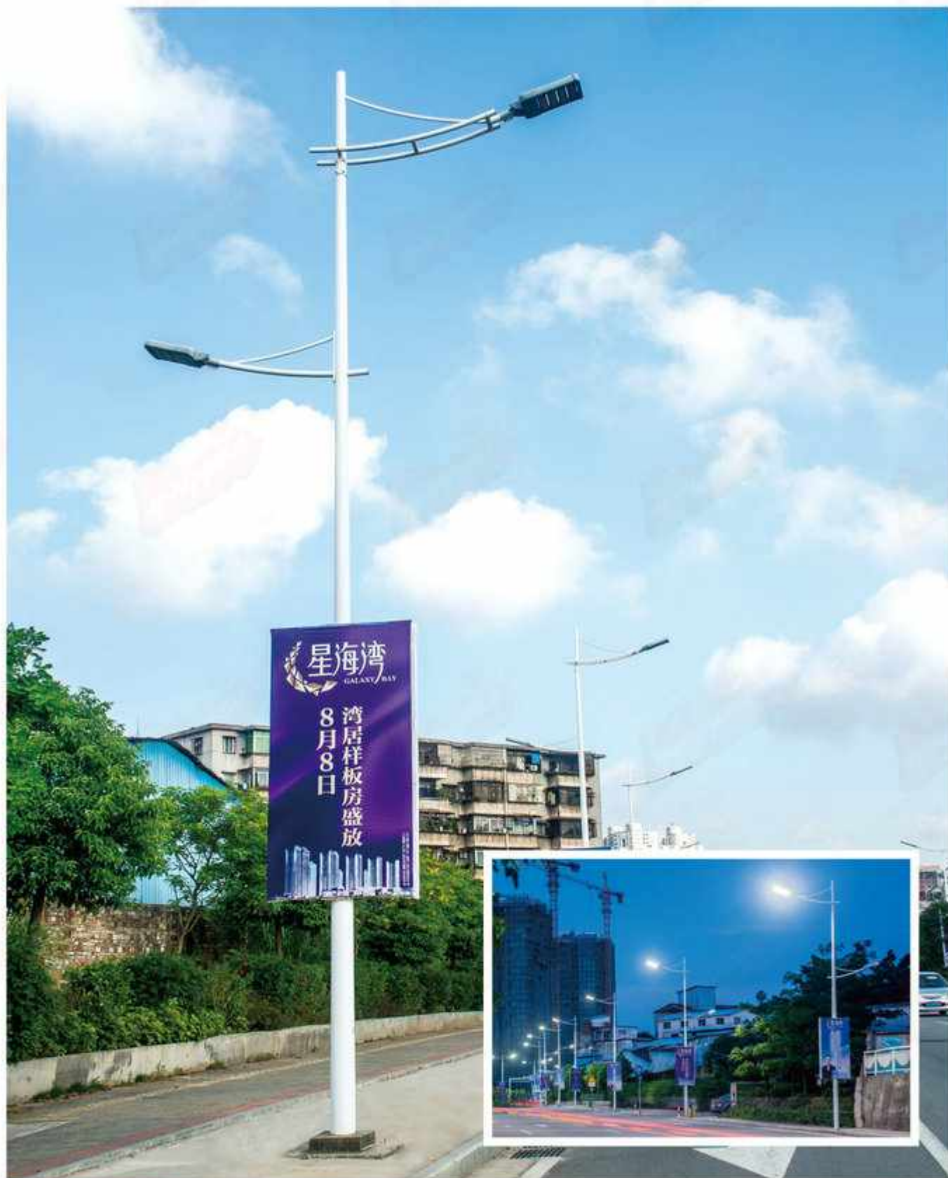
型号：永安名牌2019P11 技术参数：总高8-12m，钢铁制品；灯具铝制品，配LED光源，灯体内外热浸锌防腐处理后喷优质户外氟碳漆，灯体材料为Q235、SS400可供选择。
