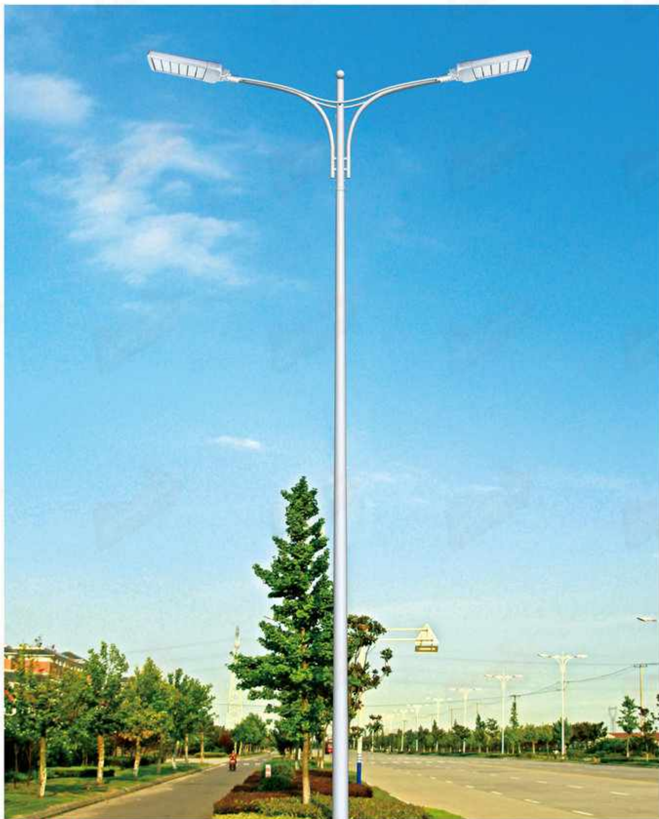
型号：永安名牌2019P5 技术参数：总高8-12m，钢铁制品；灯具铝制品，配LED光源，灯体内外热浸锌防腐处理后喷优质户外氟碳漆，灯体材料为Q235、SS400可供选择。
