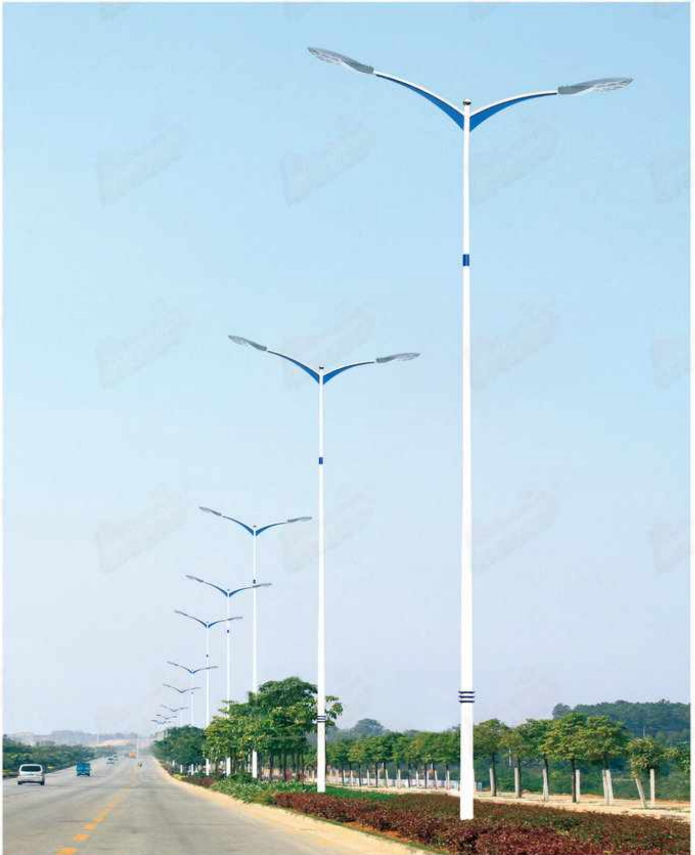
型号：永安名牌2019P59 技术参数：总高8-12m，钢铁制品；灯具铝制品，配LED光源灯体内外热浸锌防腐处理后喷优质户外氟碳漆，灯体材料为Q235、SS400可供选择。
