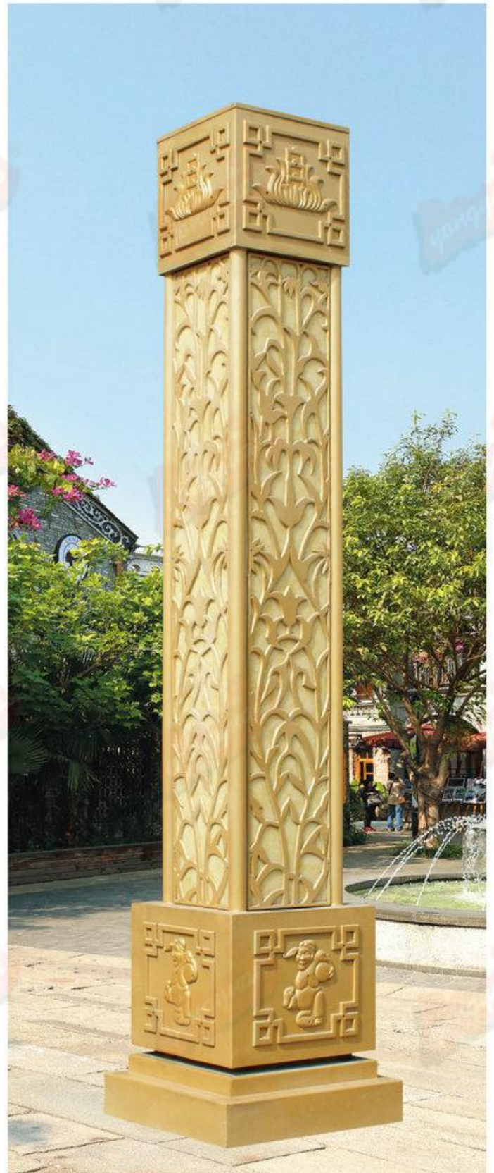
型号：永安名牌2019F8 技术参数：总高3-6m，钢铁制品，装饰花为沙铸铝制品，灯体内外热浸锌防腐处理后喷优质户外氟碳漆或户外塑，配LED光源或节能光管。
