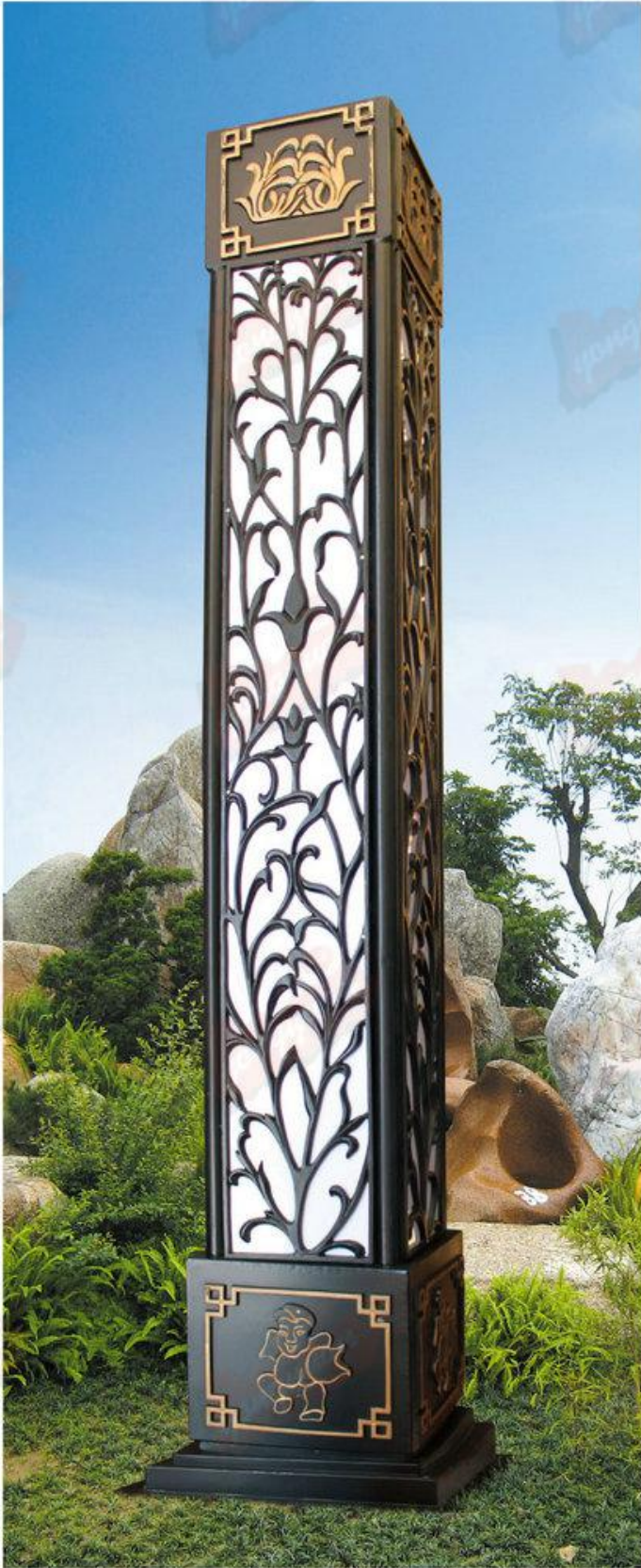
型号：永安名牌2019F7 技术参数：总高3-6m，灯体钢铁制品，装饰花为沙铸铝制品，灯体内外热浸锌防腐处理后喷优质户外氟碳漆或户外塑，配LED光源或节能光管。
