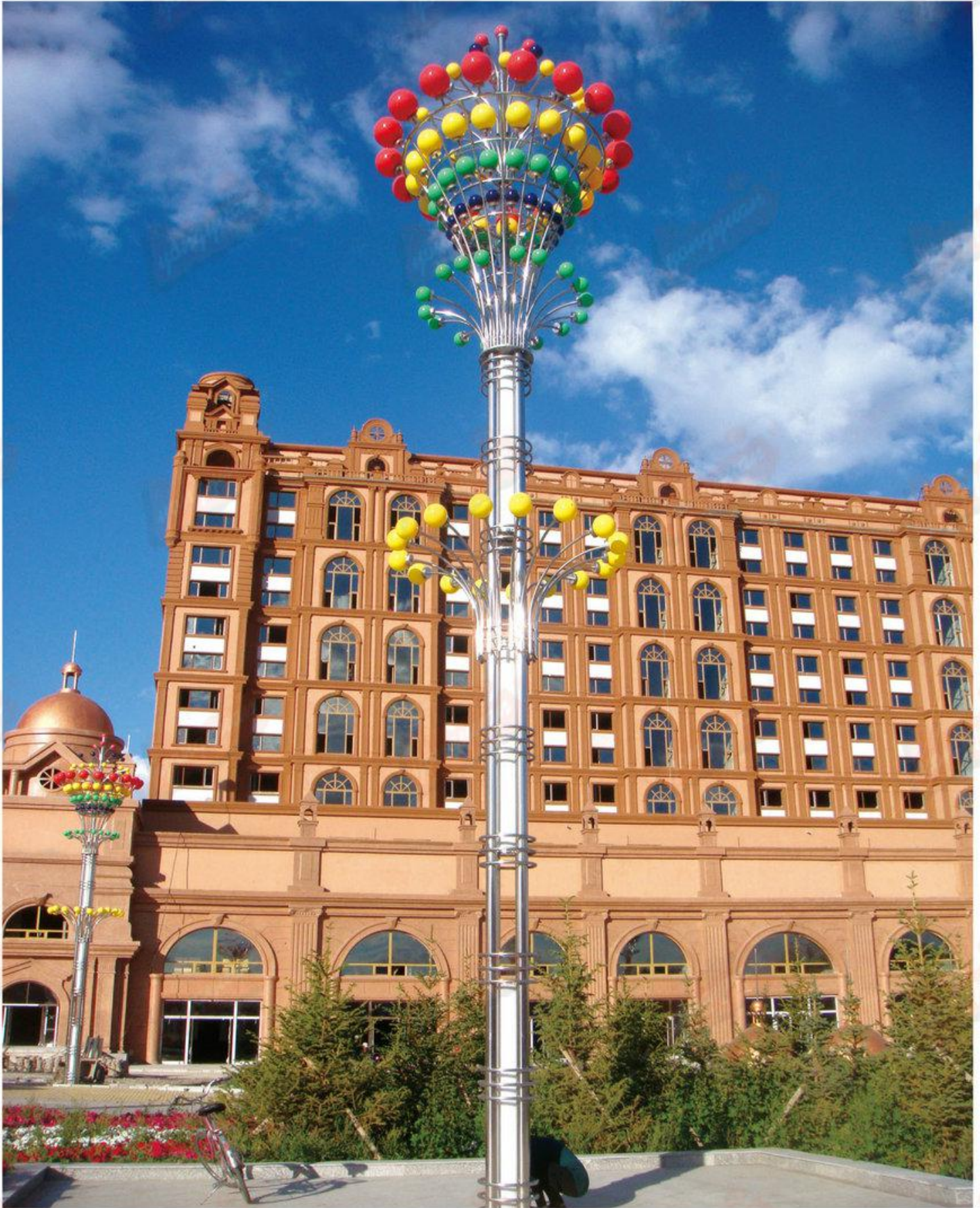
型号：永安名牌2019F338 技术参数：总高6-12m，不锈钢制品；配LED光源或节能光源，灯体材料为200系列、304系列可供选择。
